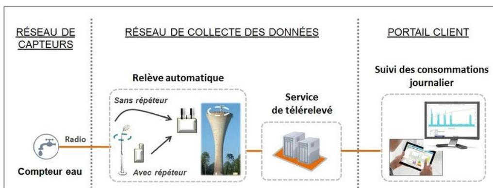
Schéma de principe de la télé-relève
