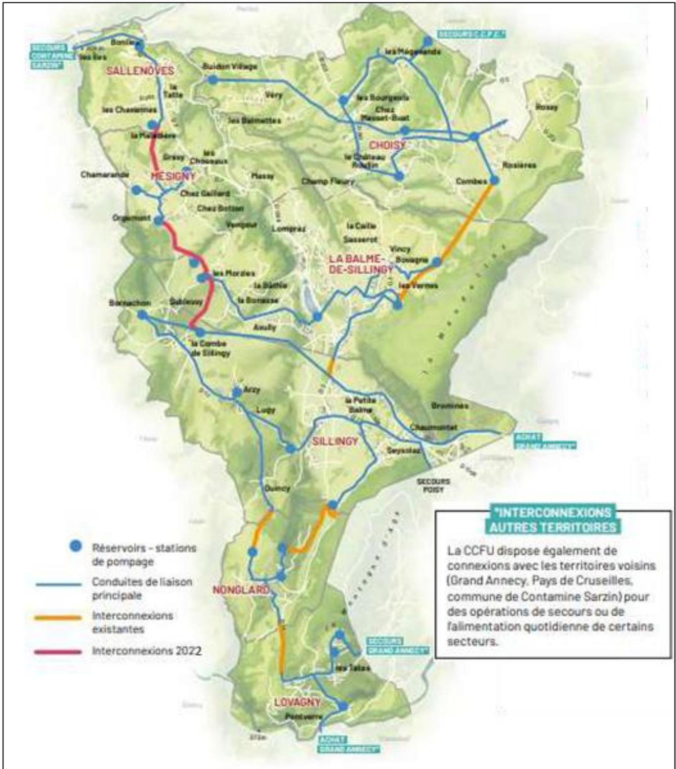
Plan des infrastructures, conduites principales et interconnexions du réseau d'eau potable de la CCFU
